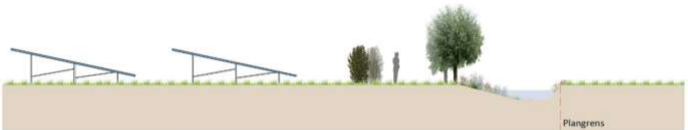
Figuur 24: Principe profiel natuurvriendelijke oever met naastgelegen recreatiepad
