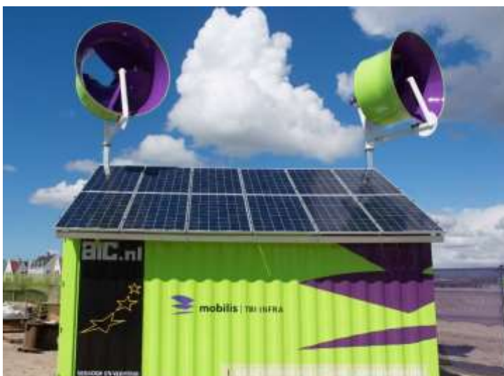
Figuur 46: Mobiele batterij voor op de bouwplaats inclusief duurzame opwekking
