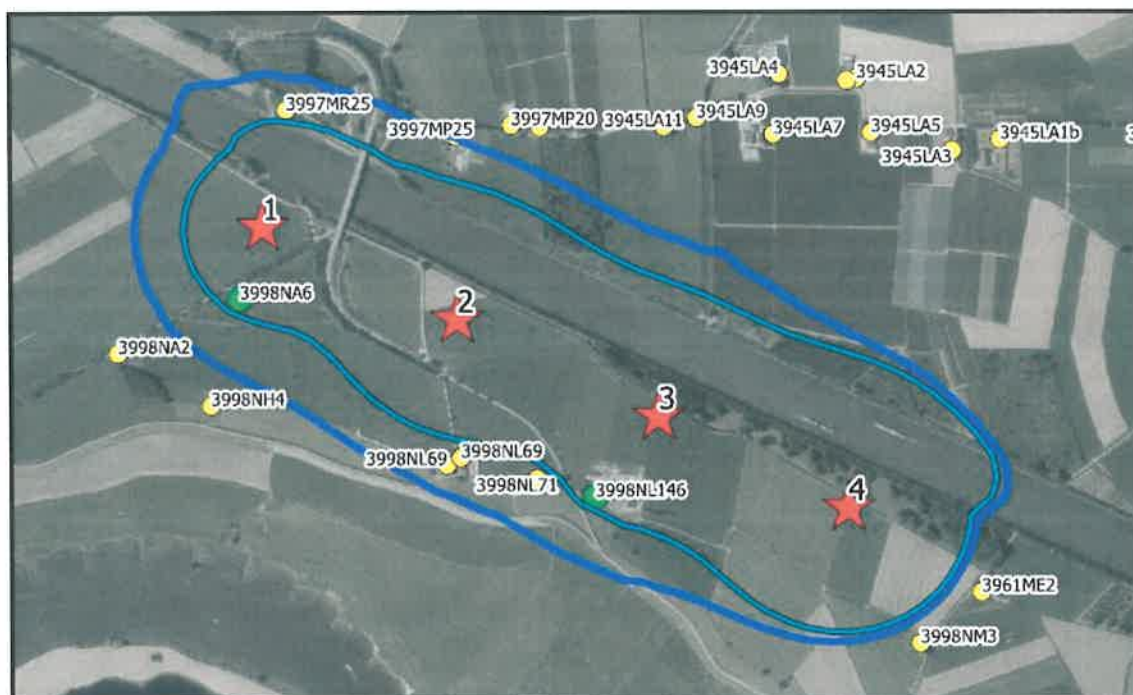
Figuur 4: geluidcontouren Vestas V150. De lichtblauwe lijn is de 47 Lden contour met mitigerende maatregelen; de donkerblauwe lijn is de 47 Lden contour zonder mitigerende maatregelen
